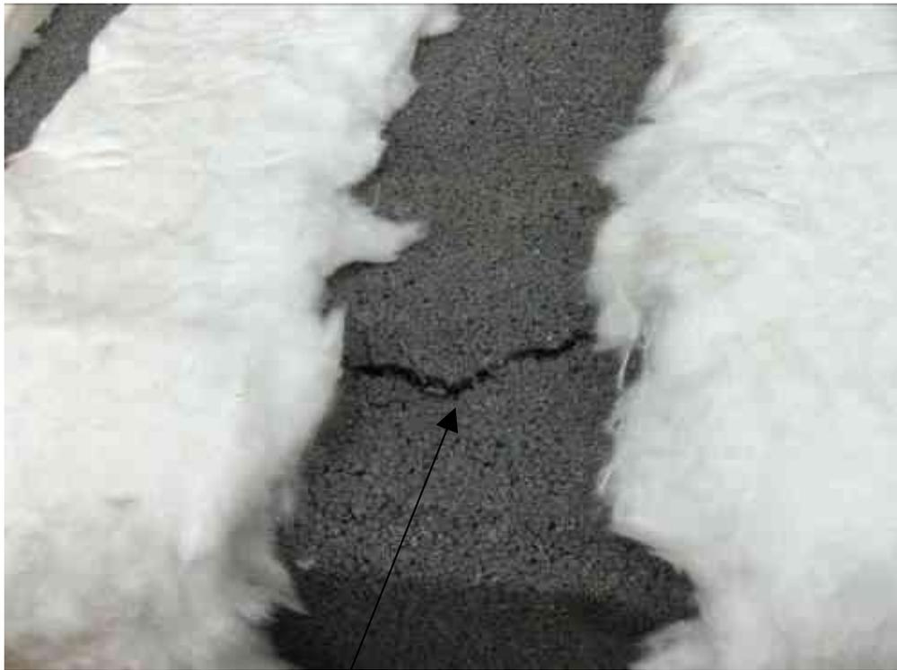
Il cavedio in cemento si è fessurato quando la temperatura all'interno del tubo era intorno ai 400 gradi
