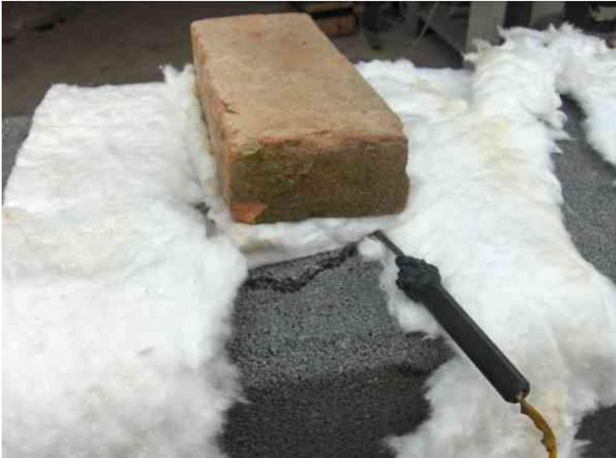
Arrivati a 1000 gradi abbiamo misurato la temperatura esterna del cavedio, avevamo impedito al possibilità di ventilazione
