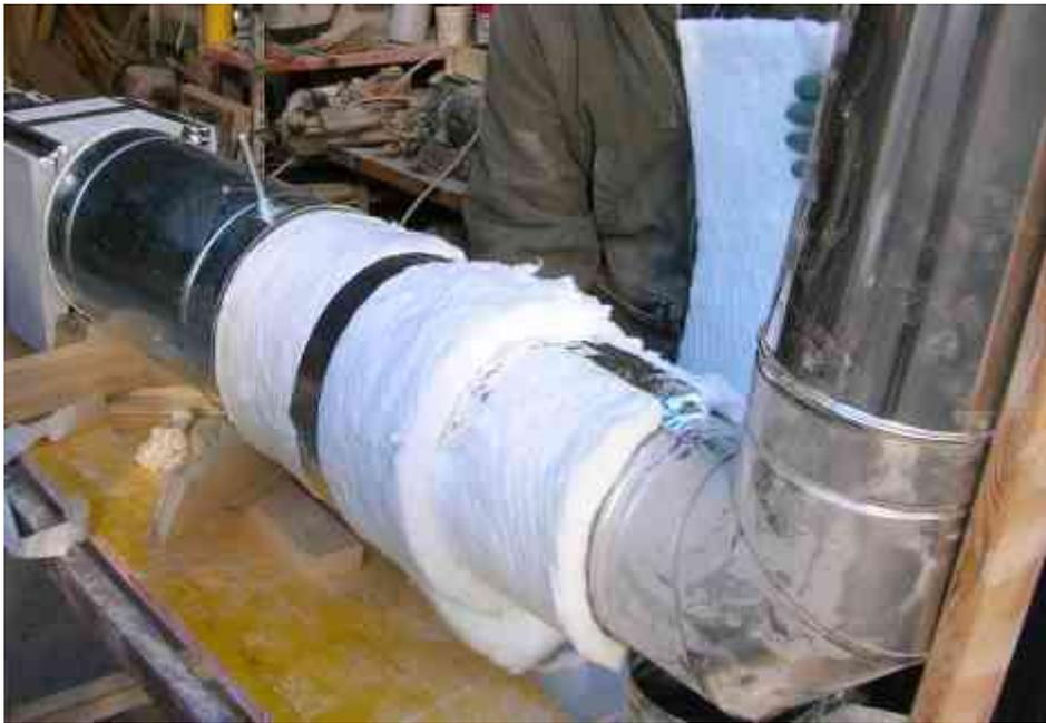
abbiamo portato la temperatura interna a 700 °C , temperatura d'esercizio per classificare l'impianto fumario T600 e poi a 1000°C per simulare l'incendio da fuliggine.
